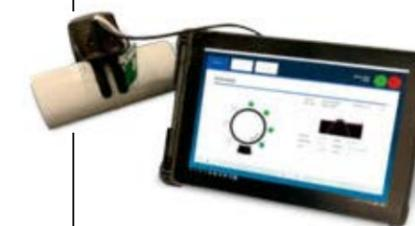
至少需要四个测量点，才能评估整个焊缝：顶部、底部、背面和正面。通常确定八个测量点来检测焊缝。对于较大的管道，也可以翻倍。
