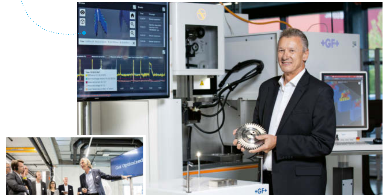
Pascal Boillat , director de GF Machining Solutions, mostró en el Capital Market Day el llamado Fir Tree Disk. Este disco forma parte de una turbina para la industria aeronáutica. Gracias a la nueva tecnología EDM Spark Track, el Fir Tree Disk se ha podido fabricar de forma aún más cualitativa.
