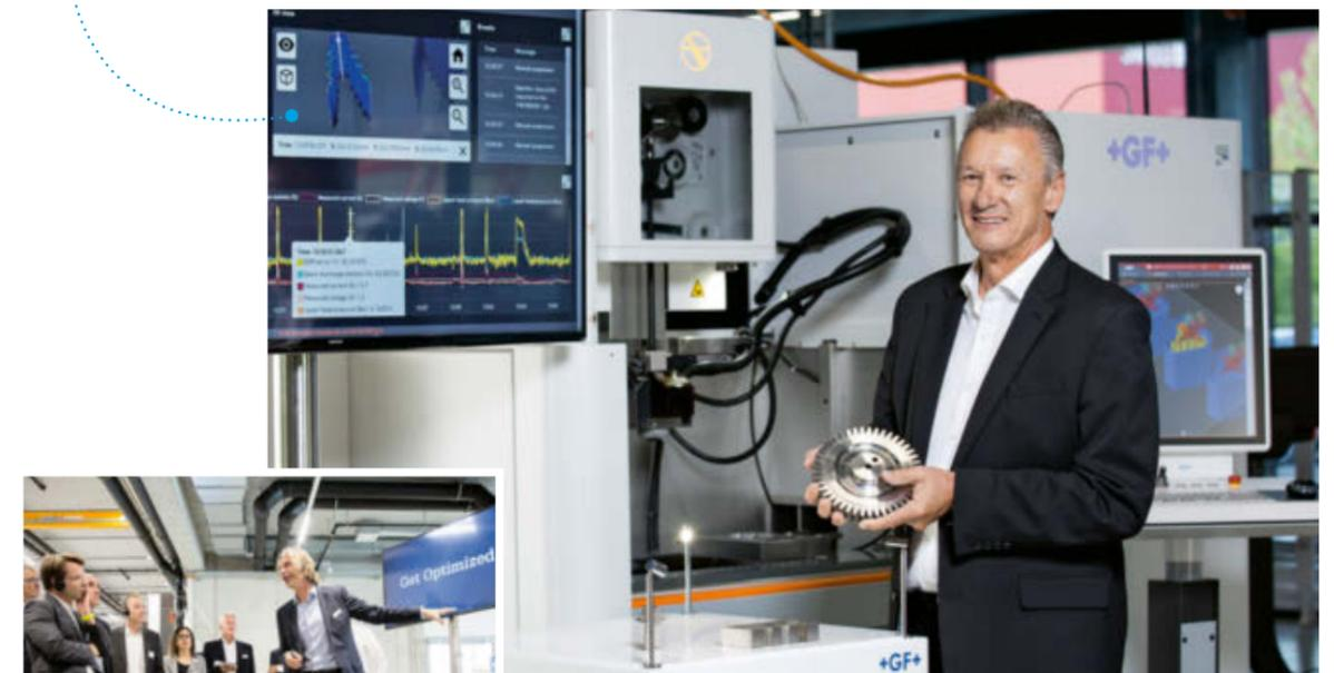
**Pascal Boillat**, Leiter von GF Machining Solutions, zeigt beim Capital Market Day eine sogenannte Fir Tree Disk. Die Disk ist Teil einer Turbine für die Luft- und Raumfahrtindustrie. Durch die neue EDM Spark-Track-Technologie konnte die Fir Tree Disk qualitativ noch hochwertiger hergestellt werden.
