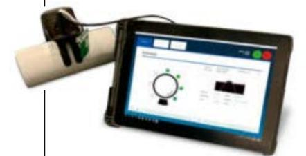
**Mindestens vier Messpunkte** sind notwendig, um die gesamte Schweißnaht beurteilen zu können: oben, unten, hinten und vorn. In der Regel werden acht Messpunkte festgelegt, um den Wulst zu erfassen. Bei grösseren Rohren können es auch doppelt so viele sein.
