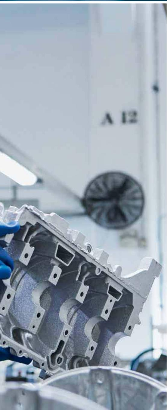
GF Casting Solutions 在苏州通过 16 台压铸机生产铝质和镁质的轻型结构组件。所生产的部件中 87% 提供给汽车行业客户，其余则提供给自动扶梯制造商。
