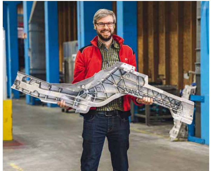
Marc Hummel, marşpiyeye şasi kolu arasındaki, 1,43 metre uzunluğundaki bağlantı parçasıyla birlikte görülüyor
