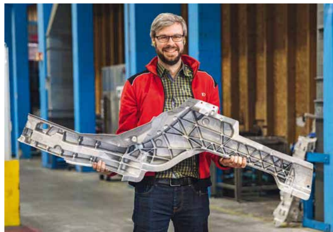
Marc Hummel con la pieza de unión de 1,43 m del reposapiés y el travesaño
