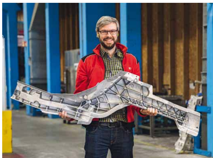
Marc Hummel mit dem 1,43 Meter langen Verbindungsteil Schweller-Längsträger
