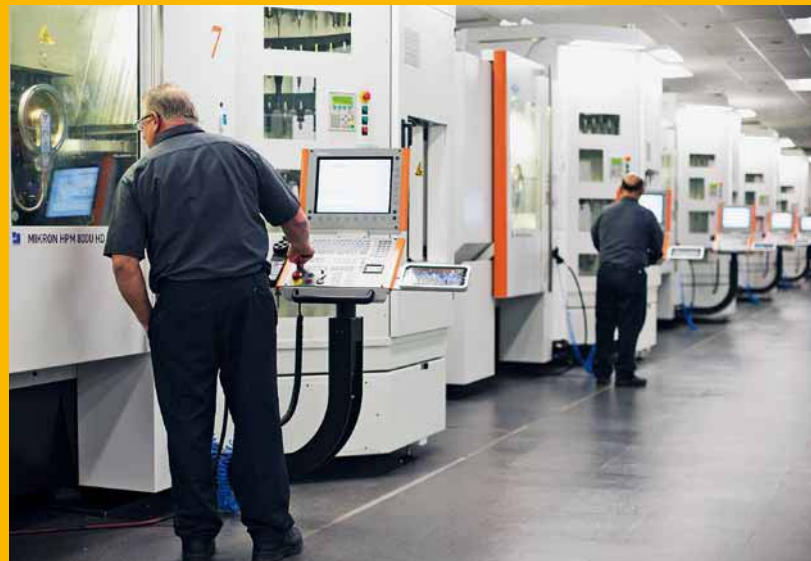
全自动生产： 加利福尼亚 Costa Mesa Toyota Racing Development 的约 200 名员工每个赛季可制造 400 多台赛车发动机。GF Machining Solutions 的八个加工中心在一个全自动生产单元中铣切所有所需发动机零部件。
