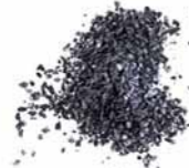
硅，2.0-3.2% 硅赋予铁更高强度，与铝一起实现更高的应用温度。
