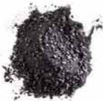
钼，0.5-1.0% 钼通过形成细致分布的碳化物改善材料的蠕变强度，从而在高温下不易变形。
