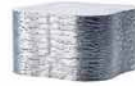
铝，2.5-3.9% 铝在高温下可形成极其稳定的氧化物，因此主要负责 SiMo1000 优秀的抗氧化性。
