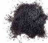
碳，3.0-3.9% 碳优化铸造特性。比起钢铁等材料该合金可以在明显的较低温度下熔化，更容易进行加工。
