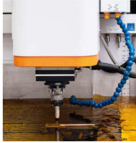
CERN, LHC parçacık hızlandırıcı için narin parçaları üretmek için Mart 2021'den bu yana CUT P 800'e güveniyor: Makinenin içindeki muazzam enerji, metallerin freze makinesiyle olduğundan daha hassas bir şekilde işlenebilmesini sağlıyor.
